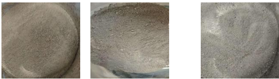
(a) 待改良土 (b) 钢渣微粉 (c) 生活垃圾焚烧炉渣
